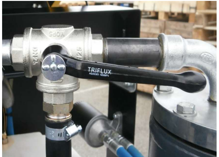
Configuration position refroidisseur final activé (circuit 2)
