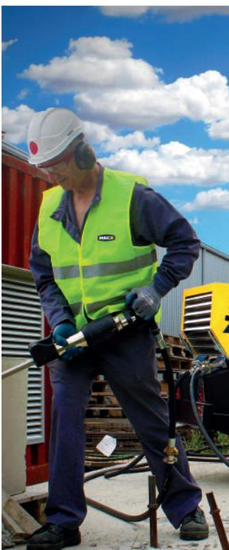
Mit einem Presslufthammer kann eine Vielzahl von Arbeiten auf der Baustelle durchgeführt werden, von der einfachen Oberflächenrenovierung bis hin zu schweren Abbrucharbeiten. **Der Einsatz von MAC3-Prallhämmern kann an jede Situation angepasst werden.**
